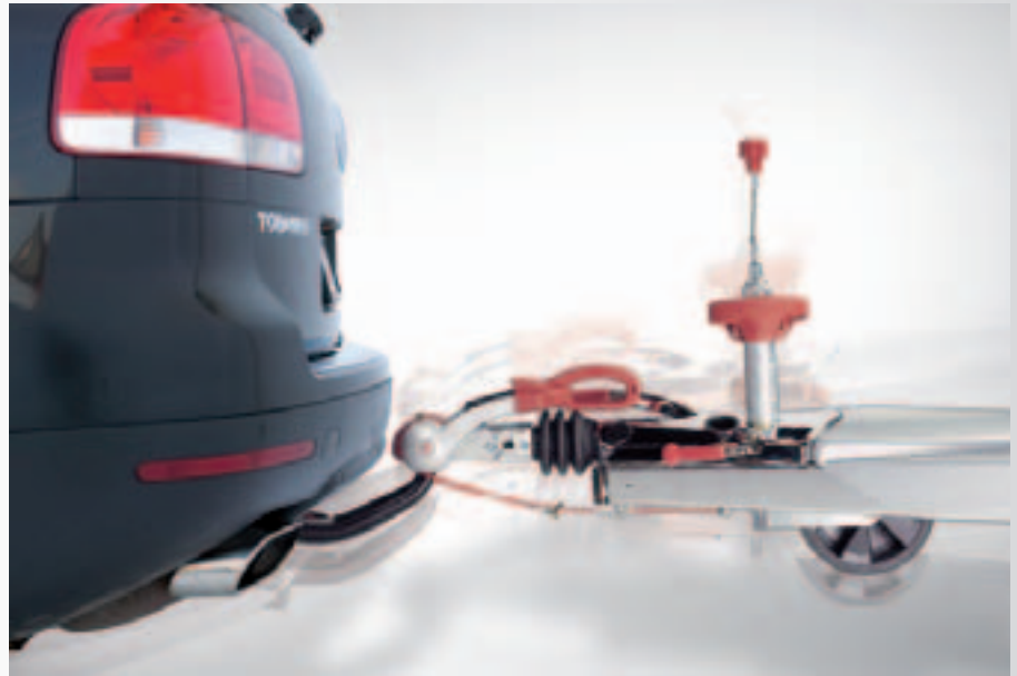
Die Sicherheitskupplung verhindert Nickbewegungen.
