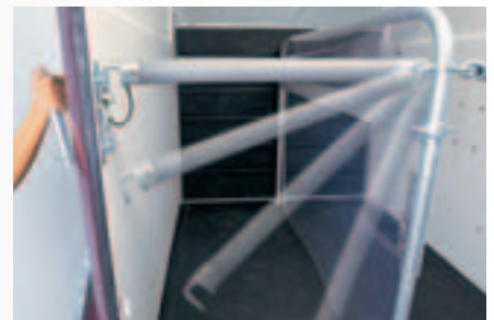
Das Boxenstangen-Paniksystem von Böckmann. Foto: Böckmann
